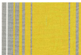
Rotura de hilo corto aceptable, vinculado con permeabilidad a la luz debido a la rotura de la cinta o hilo de tiro con alta tensión durante la confección.
